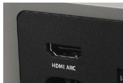
HDMI z eARC pojawia się w nowoczesnych wzmacniaczach stereo coraz częściej, WiiM Amp Pro ma też dekodery Dolby Digital
